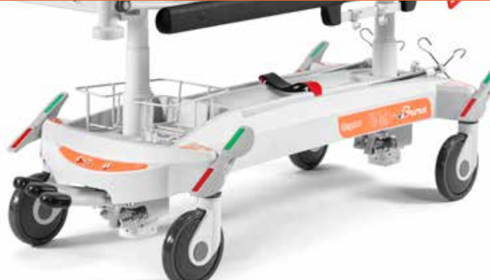
Basamento con carter facilmente lavabile e sanificabile, con una particolare sagomatura che ospita: vano bombole di varie dimensioni, vano porta oggetti e due vani per posizionare l'asta flebo quando non utilizzata.
